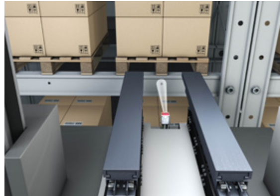
IPS 200i: 托板仓中杆的精准定位
